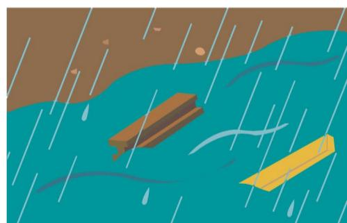
河岸の護岸工事中、豪雨により仮締切が決壊し、工事現場に集積していた植生ブロック等の工事用材料、鋼矢板等の工事用仮設材が流出した。
